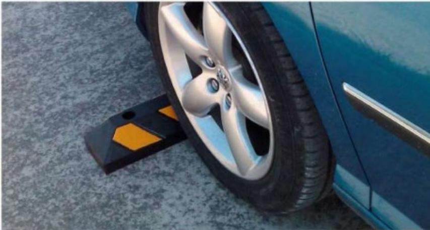
Compuesto de Caucho SBR, diseñado con cintas amarillas, señalan la zona reservada para estacionar. Se instala como tope de neumático. Las franjas amarillas facilitan su visualización, y los orificios permiten instalarlos sobre concreto o asfalto mediante pernos de fijación.
