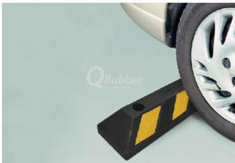
Compuesto de Caucho SBR, diseñado con cintas amarillas que señalan la zona reservada para estacionar. Se instala como tope de neumático. Las franjas amarillas facilitan su visualización, y los orificios permiten instalarlos sobre concreto o asfalto mediante pernos de fijación.
