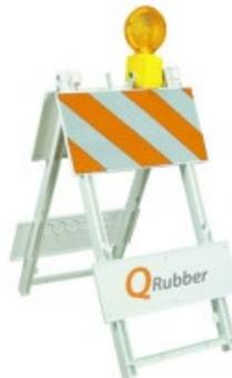
Lámparas destellantes para señalización de tránsito en zona de obra o desvío provisorio. Fabricadas en polietileno 100% virgen y lente de policarbonato, posee abrazadera metálica para adosar a tambor, viga u otro soporte. Su cabeza gira hasta 90° lo que permite ser visible en diferente orientación. Posee llave para encender y fijar.
