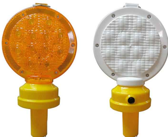
Lámpara unidireccional, material de policarbonato y plástico resistente. Posee un fotosensor que al bajar la luminosidad ambiente activa la luz con un destello intermitente de buena potencia. También tiene gancho para colgar
