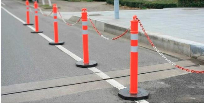
Hito para señalización y control de tránsito. Fabricado de poliuretano y al ser colapsado se retrotrae. Posee cintas reflectantes de alta intensidad tipo panel que aseguran su visibilidad, incluso en zonas y períodos de luminosidad reducida como la noche o bajo neblina
