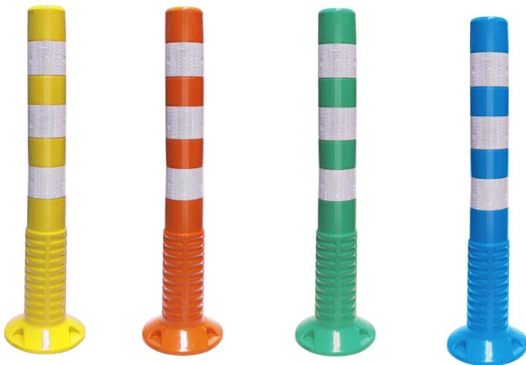
Hito para señalización y control de tránsito. Fabricado de poliuretano y al ser colapsado se retrotrae. Posee cintas reflectantes de alta intensidad tipo panel que aseguran su visibilidad, incluso en zonas y períodos de luminosidad reducida como la noche o bajo neblina
